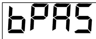
6. Для запуска стабилизатора в нужном режиме работы, следует кнопкой «Выбор индикации» на лицевой панели выбрать соответствующий режим. Режим «STAB» соответствует режиму **стабилизации**, а «bPASS» - режиму электронного **транзита** (байпас). Выбор режима можно осуществить для каждой фазы (А, В, С) независимо друг от друга.
