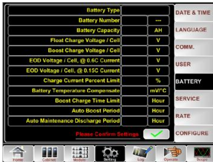
Рисунок 5-1. Настройка параметров с помощью ЖК-дисплея на панели управления
