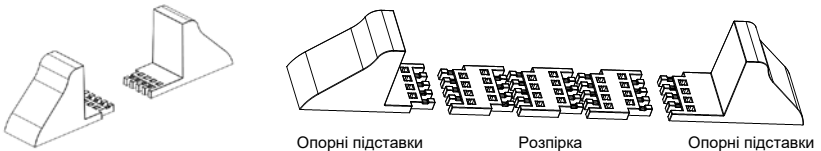
Рис. 2-1: Встановлення опорних підставок з розпірками
