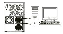
Не подключайте к выходным разъемам ИБП лазерный принтер или другие периферийные устройства, не имеющие непосредственного отношения к компьютеру.
