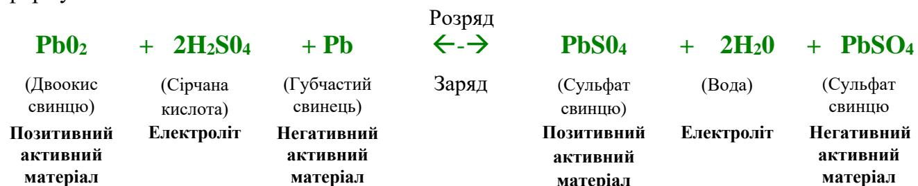
Під час розряджання діоксид свинцю в позитивних пластинах і губчастий свинець у негативних пластинах реагують із сірчаною кислотою в електроліті та поступово перетворюються на сульфат свинцю; протягом цього процесу концентрація сірчаної кислоти зменшується.
