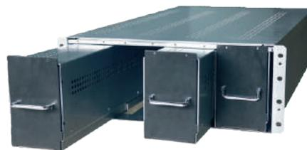
Вариант 1. Модуль с режимом "Горячей замены"
