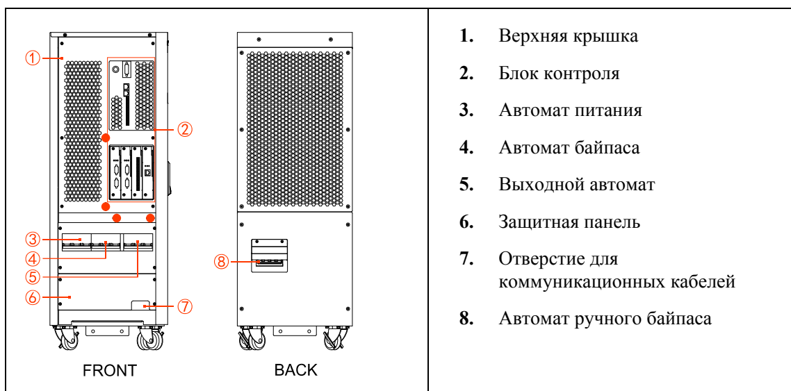
Рис 2.9 Структурная схема расположения для MZ3310, MZ3320, MZ3330, MZ3340
