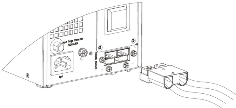
Рис. 4. Разъем для подключения внешнего аккумулятора
