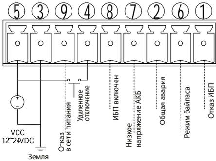
Рис. 7. Схема соединений для разъема для внешних подключений
