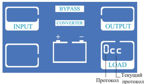
8) Нажмите кнопку ON/OFF для ввода протокола и отображения текущих установок.
