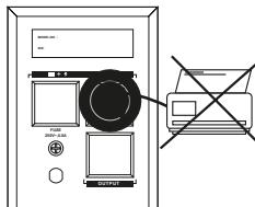
Включите ИБП, переведя выключатель питания, расположенный на передней стороне изделия, в положение «ON».
