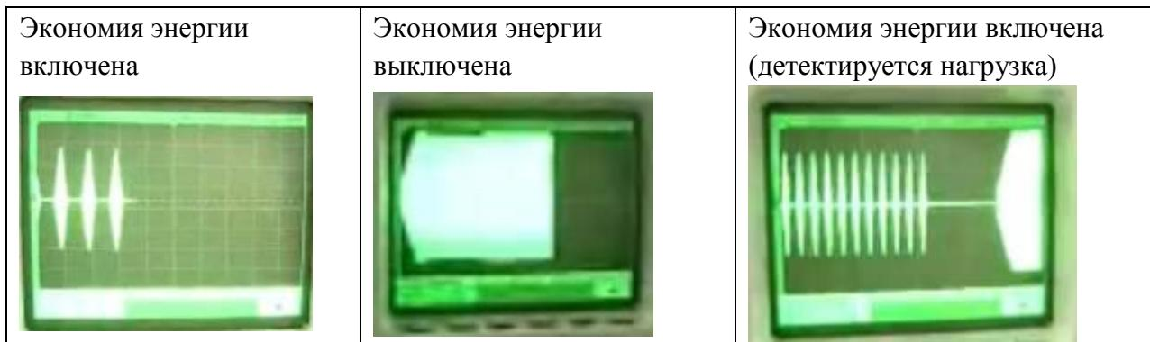
**Примечание: минимальная мощность нагрузки, которая выводит инвертор из «спящего» режима (Power Saver On) – 25 Вт.**
